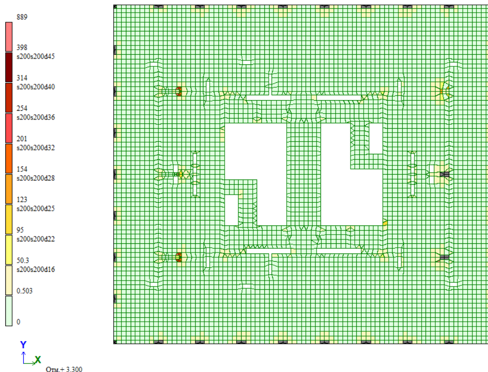
Рисунок. Требуемое поперечное армирование плит на 1м 2 .
