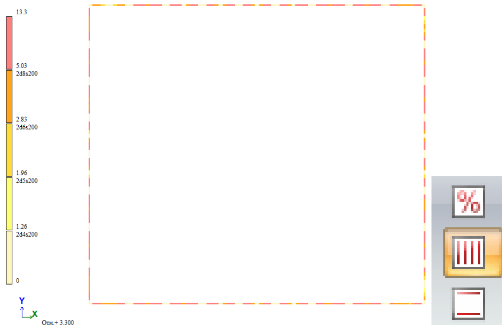
Рисунок. Требуемое поперечное армирование балок. Вертикальное направление.
